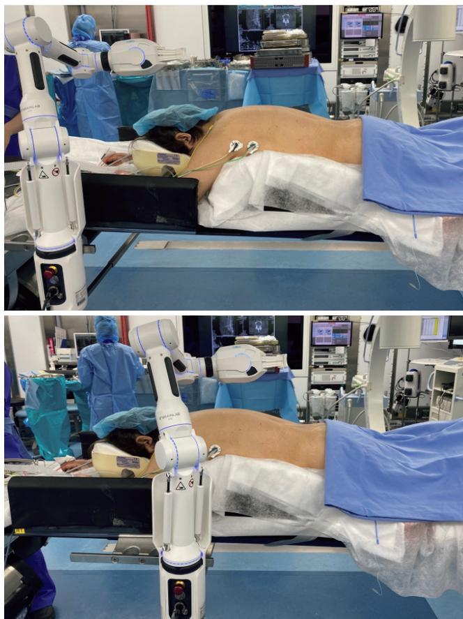
図2 CT撮像時はロボットアームを頭側によけておき（上）、Pilot Hole作製時にベッドレールごと術野にロボットアームが届く位置まで移動する。
