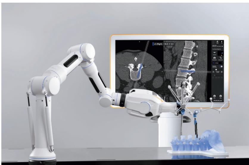
図1 ベッド設置型の脊椎手術支援ロボットCirq®
