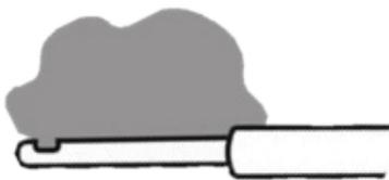
図7 セメントニードルの先端形状
